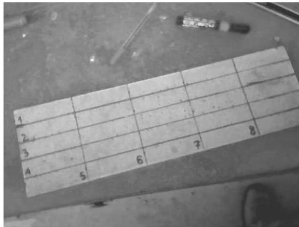
**FIGURE 2 – PLATE OF MORTAR MARKED ALONG THE LENGTH TO BE MEASURED**
